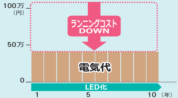
■ランニングコスト(電気代+ランプ費)比較 比較条件:ベースライト:HF32W×2灯 200台 電力料金目安単価:25円/kWh(税抜)、年間点灯時間:3000時間
